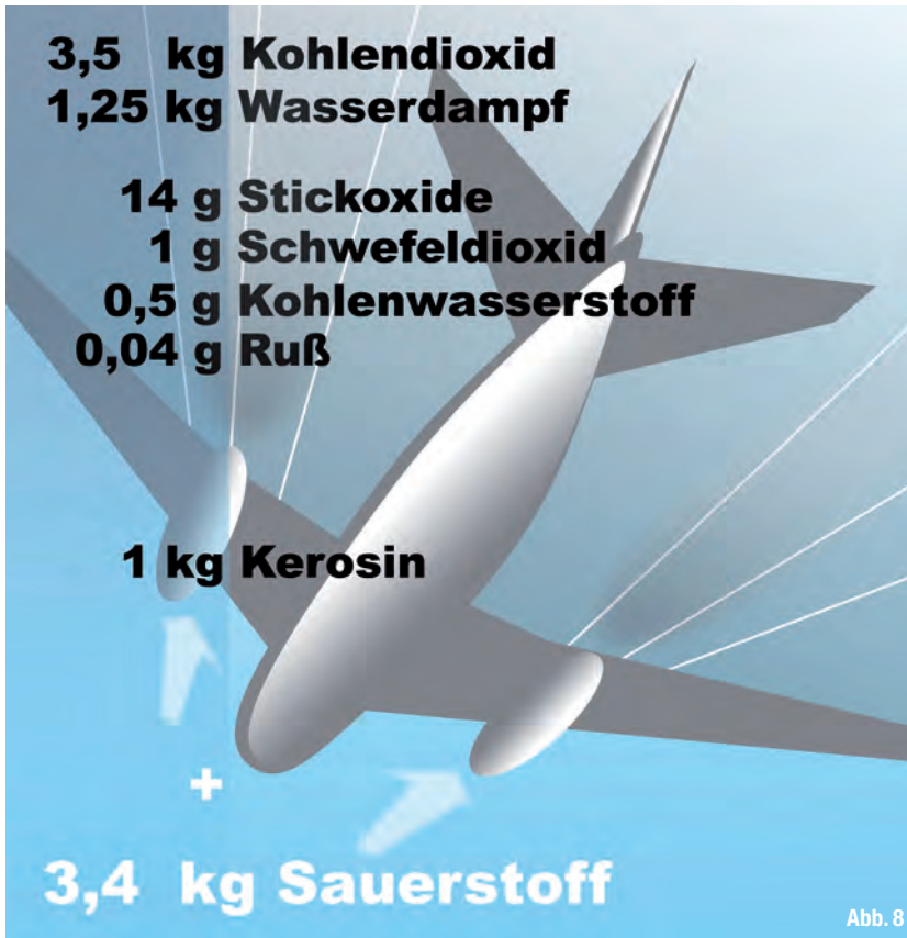
Abb. 8 _ Abbau von Kerosin.
